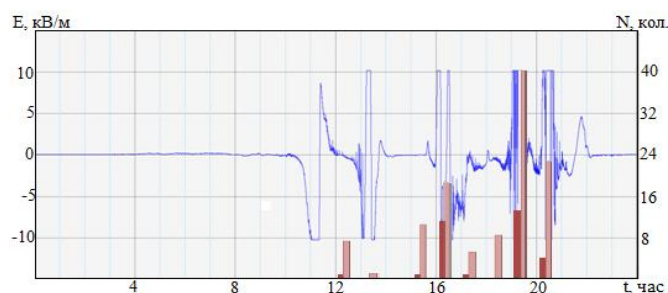
Рис. 6. Ход напряженности электрического поля и количество разрядов облако-земля от времени, за 17 мая 2013 года (— количество положительных разрядов, — количество отрицательных разрядов)
