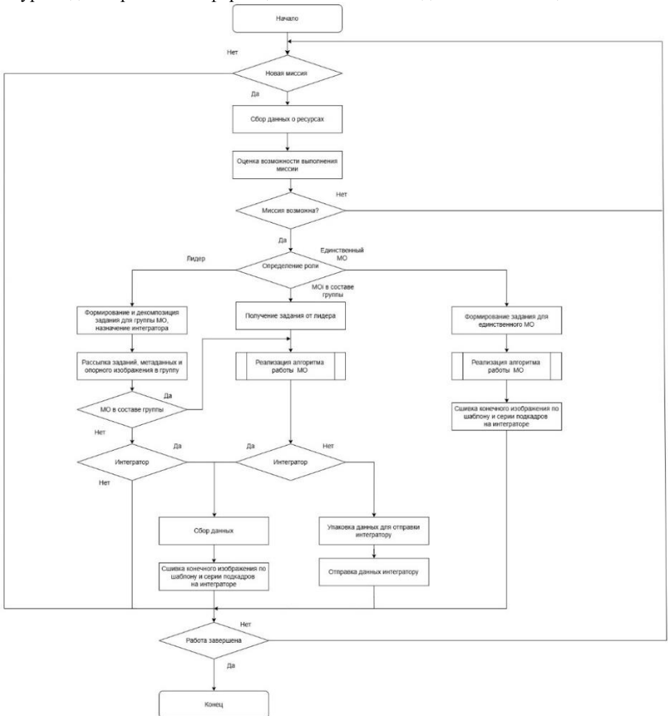
Рисунок 7 – Алгоритм работы мобильного объекта при формировании изображений высокого разрешения в группе
