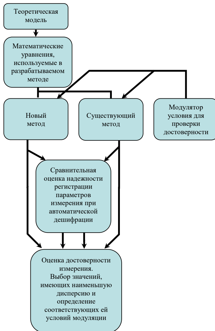
Рисунок 44 – Структура метода анализа достоверности регистрируемой информации и выявления источников погрешностей
