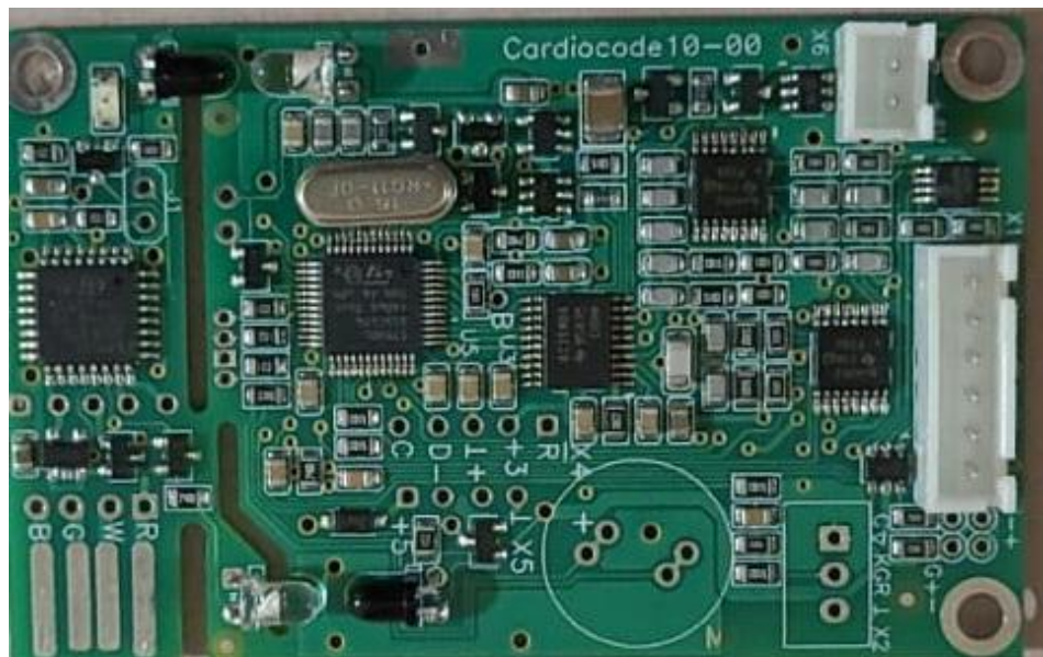
Рисунок 53 – Электронный блок серийно выпускаемого анализатора «Кардиокод».
