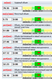
Рисунок 7 – Скриншот дисплея разработанного прибора, отображающий измеренные объёмы крови с помощью ЭКГ и её производной
