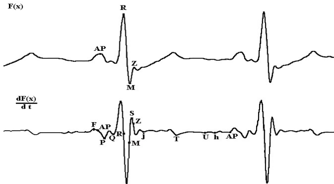
Рисунок 4 – График ЭКГ и её графическая первая производная
