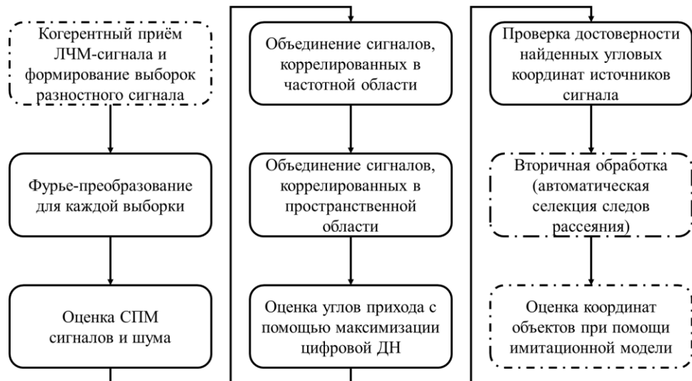
Рис.3.2 Алгоритм обработки данных ЛЧМ ИР
