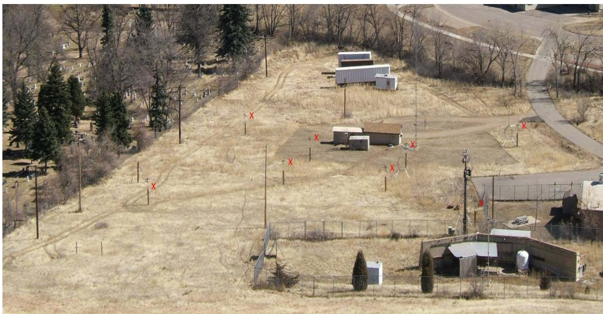
Рисунок П1.3 - Антенное поле ст. Boulder (крестиками помечены приемные антенны диназонда)
