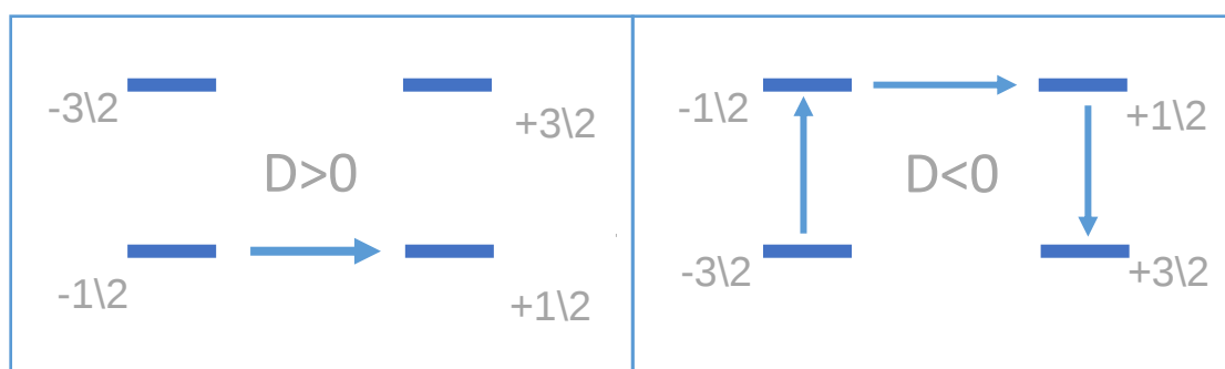
Рисунок 2 - Механизм магнитной релаксации при D > 0 и D < 0 на примере системы с S = 3/2
