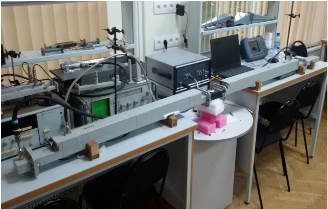
Рис. 2.7 Волноводная секция для измерения металлодиэлектрических структур в диапазоне 2,2 – 4,2 ГГц
