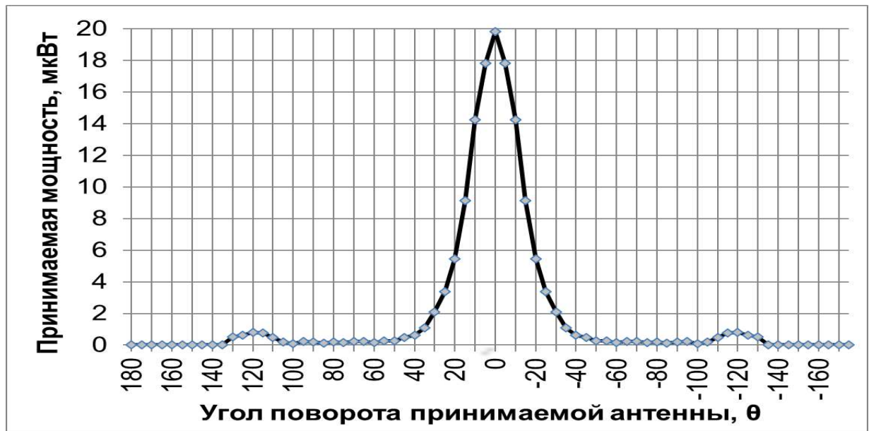
Рис.2.3 Форма диаграммы обратного рассеивания металлического зеркала размерами 72x72мм на частоте 22 ГГц
