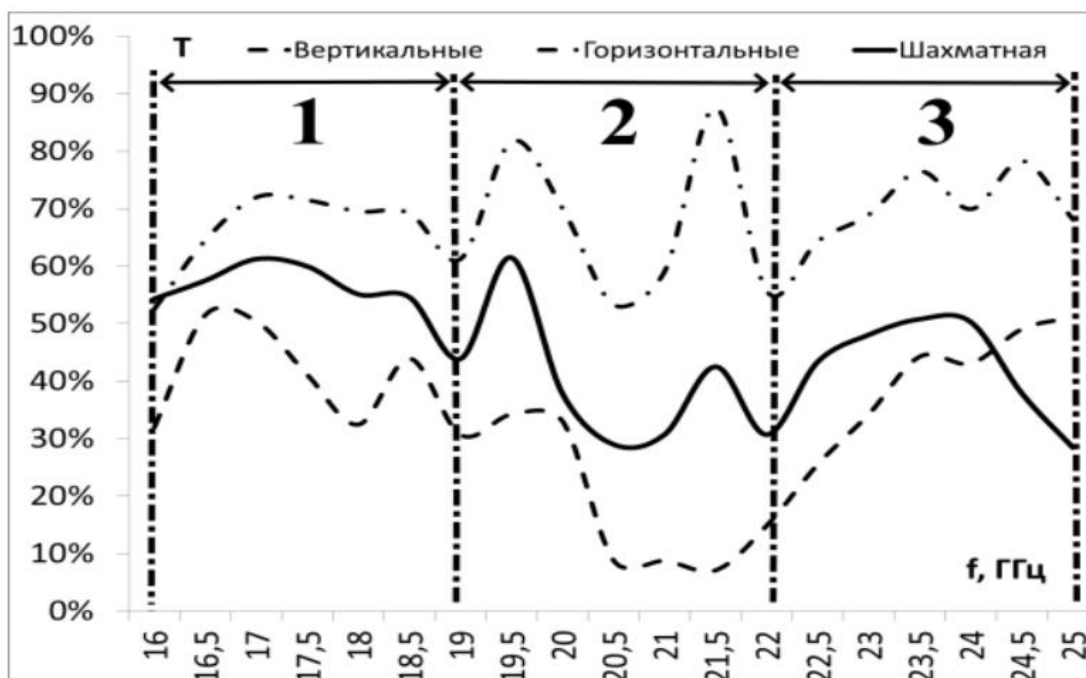
Рис. 3.4 Характерные частотные отрезки для двунаправленной метаструктуры из сонаправленных и ортогональных элементов
