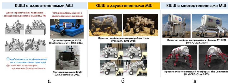
Рис. 3. Варианты реализации КШШ типа «колесо на ноге»
