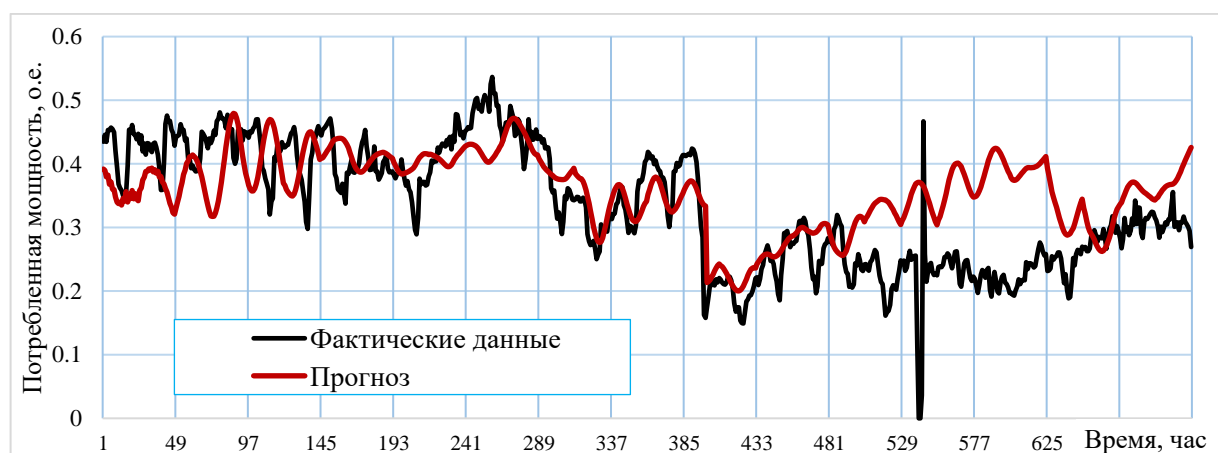
Рисунок 2.4 – Тестирование НС-модели прогнозирования (сравнение фактических и прогнозных данных).
