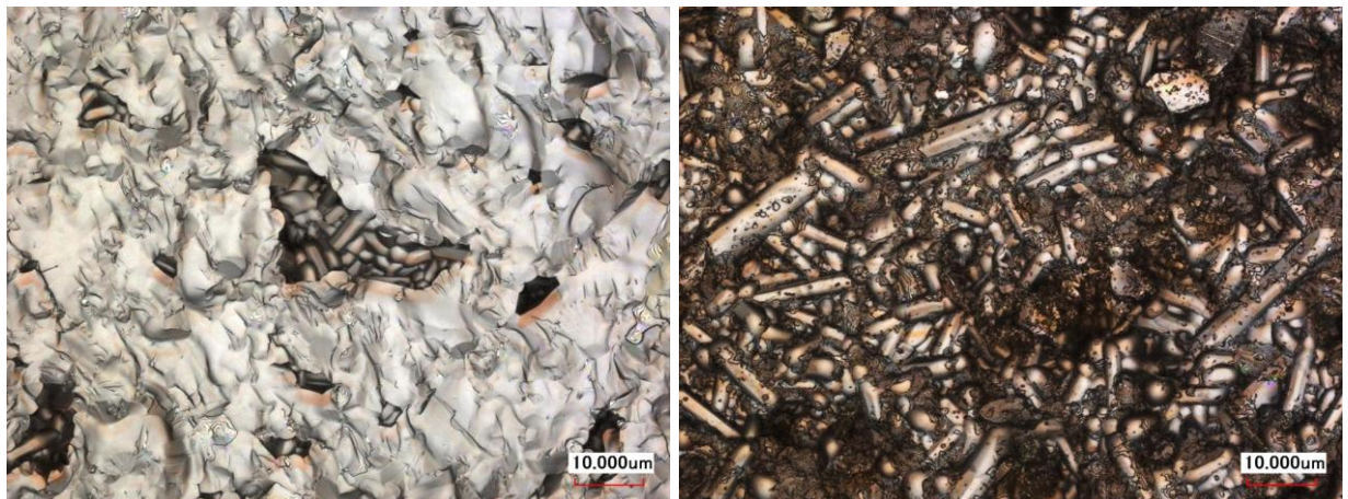
Рисунок 3.3 — Оптические микроснимки скола керамики BNFN (маркер 10 мкм)
