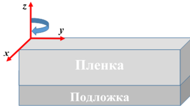
Рисунок 2.10 — Схематическое изображение плёнки и определение конфигурации, используемой для описания образца
