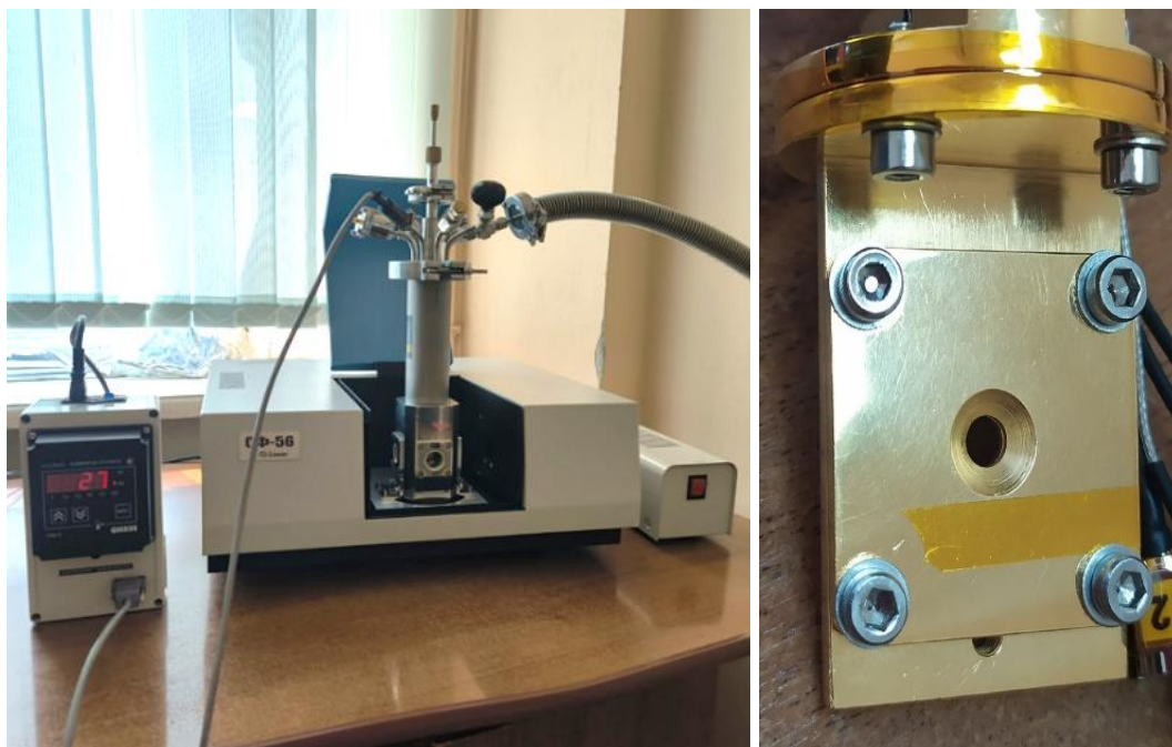
Рисунок 2.5 — Фото криостата в СФ-56 (слева) и оптический держатель образцов (справа) в криостате LN-121-SPECTR
