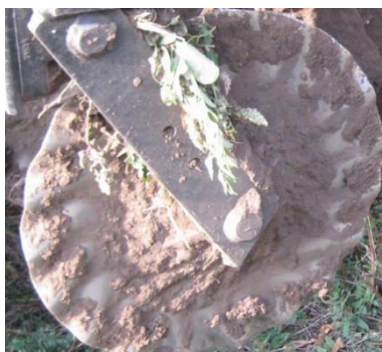
Налипание почвы на рабочие органы при посеве ранней весной
