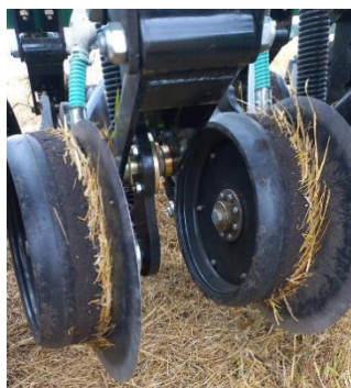
Налипание почвы и пожнивных остатков на монодисковый (дисково-анкерный) сошник при севе ранних яровых.
