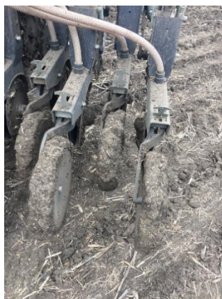
Налипание почвы на рабочие органы при посеве ранней весной
