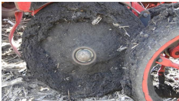
Налипание почвы на сошник с дифазным расположением дисков при севе ранних яровых культур.
