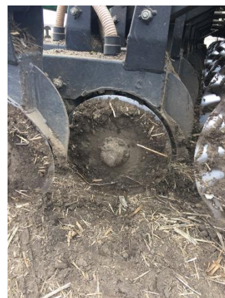
Налипание почвы на рабочие органы при посеве ранней весной
