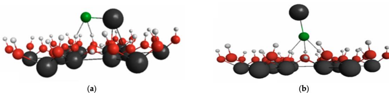
Рисунок 6.7 – Оптимальные положения молекулы NaCl вблизи гидроксильной поверхности каолинита: (a) молекулярная ось параллельна поверхности, (b) молекулярная ось перпендикулярна поверхности.
