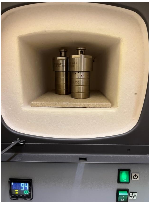
Рисунок 4 – Синтез МОК \text{Co}_3(\text{HCOO})_6 в автоклаве гидротермальным методом
