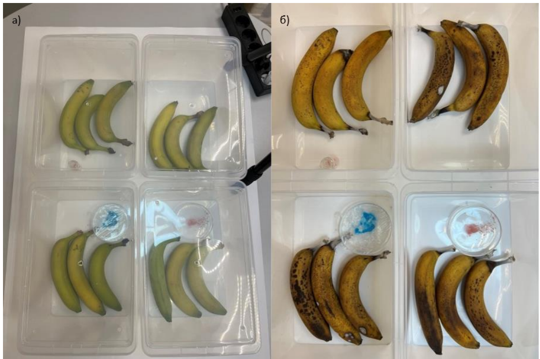
Рисунок 53 – Лабораторные тесты различных МОК, дозированных 1-МЦП, на плодах банана. а) начало эксперимента -1 день, б) завершение эксперимента – 17 день
