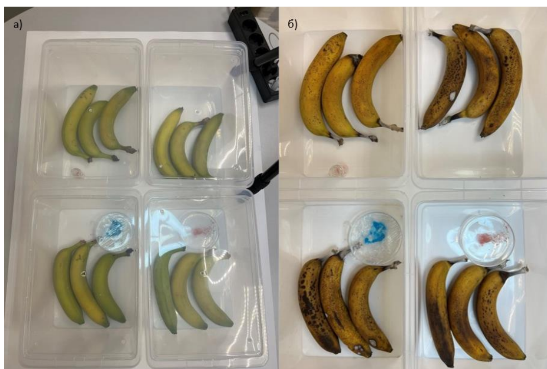
Рисунок 9 – Лабораторные тесты различных МОК, функционализированных молекулами 1-МЦП, на плодах банана.
