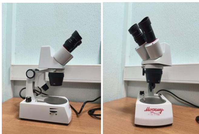
Рисунок 18 – Оптический микроскоп стерео Микромед МС-1 Вар.2С Digital с увеличением 20-40-х, для сортировки и изучения частиц
