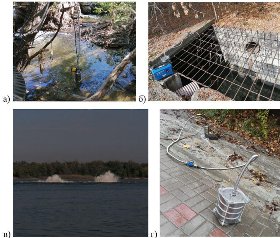
Рисунок 54 – Отбор сточных вод (а – в транзитных дренажных городских магистралях, б – в централизованных магистралях водоотведения (коллекторах), г – централизованные выпуски сточных вод с очистных сооружений, в – атмосферный дождевой сток)
