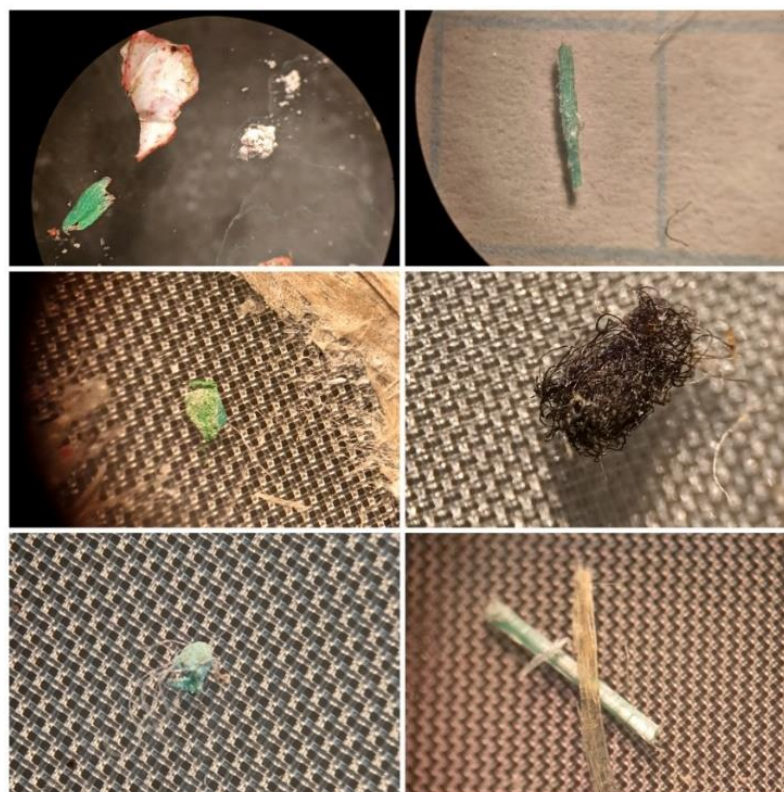
Рисунок 19и– Микропластик под микроскопом стерео Микромед МС-1 на этапе визуальной сортировки
