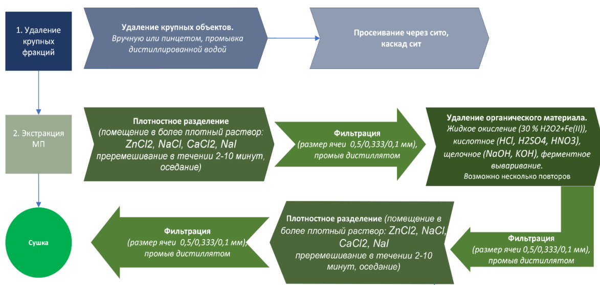
Рисунок 15 – Схема этапов обработки проб воды для обнаружения микропластика (составлено по: [168])
