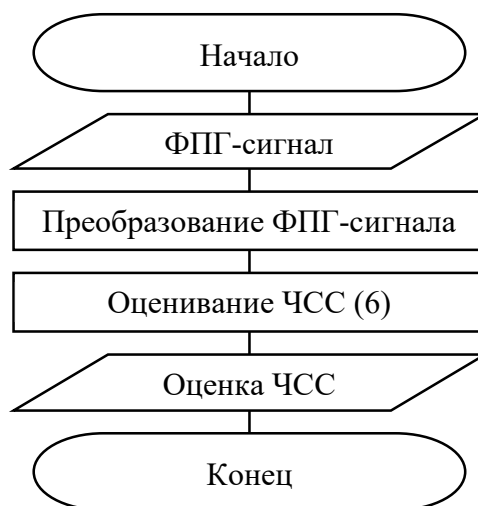
Рисунок 8 – Укрупнённая схема операций в фоновом потоке в процессе оценивания ЧСС в реальном времени по изображениям с видеокамеры
