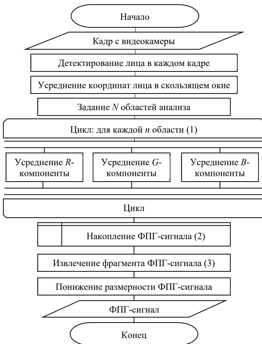
Рисунок 7 – Укрупнённая схема операций в основном потоке в процессе оценивания ЧСС в реальном времени по изображениям с видеокамеры
