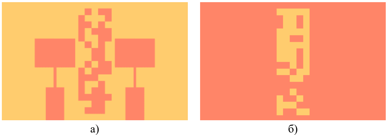
Рисунок 3.10 – АР с наибольшим значением ЦФ; вид сверху (а) и вид снизу (б). P_{mut} = 0,03 , P_{ind} = 0,03 , ЦФ = 0,955
