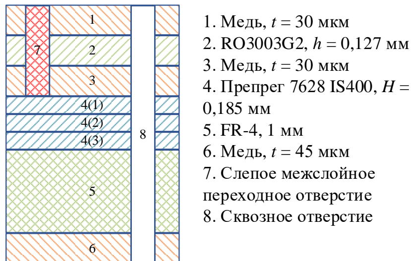
Рисунок 4.37 – Схема размещения слоев СВЧ – платы
