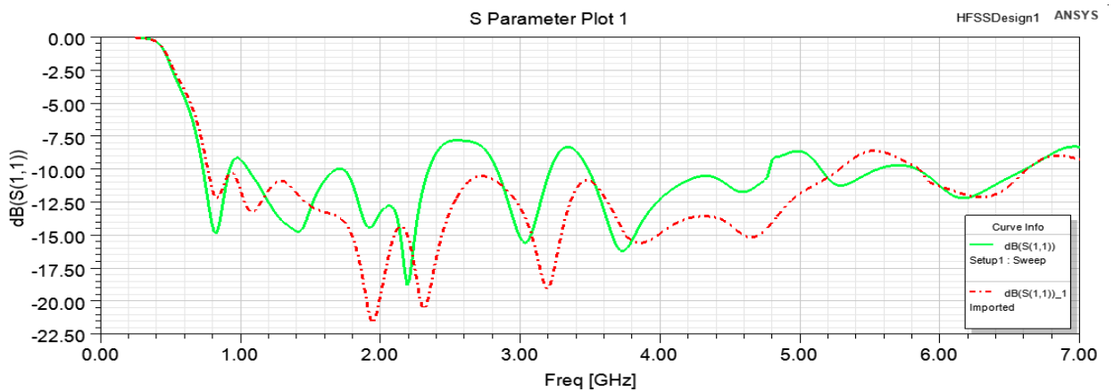
Рисунок 3.18. Частотные зависимости обратных потерь S_{11} при \epsilon = 3
