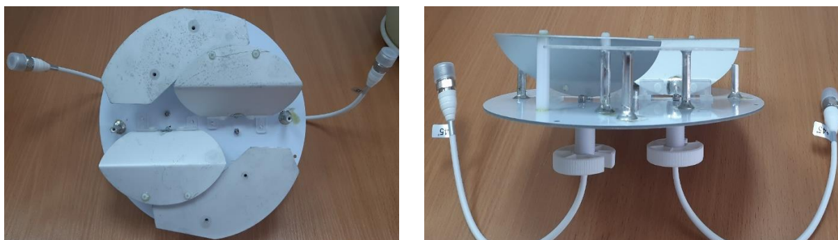
Рисунок 3.1. Прототип антенны МИМО 2×2 [120]
