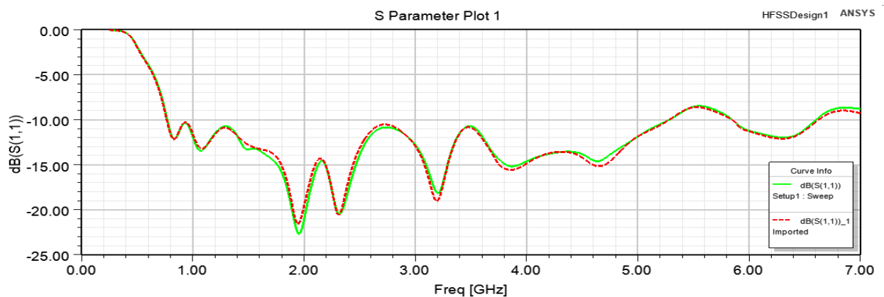
Рисунок 3.10. Частотные зависимости обратных потерь S_{11} при \epsilon = 1
