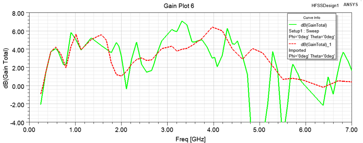
Рисунок 3.40. Частотные зависимости КНД при \epsilon = 8
