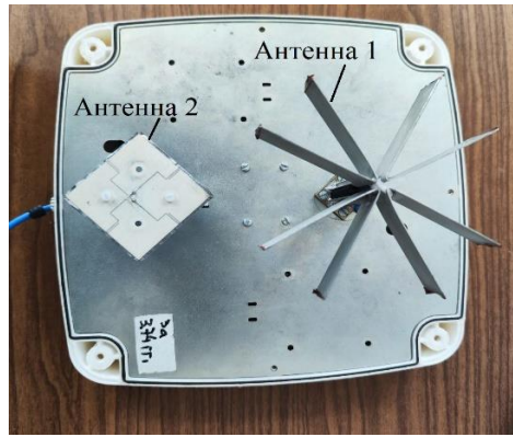
Рисунок 4.2. Сдвоенная трехдиапазонная ММО-антенна 2×2 (прототип)
