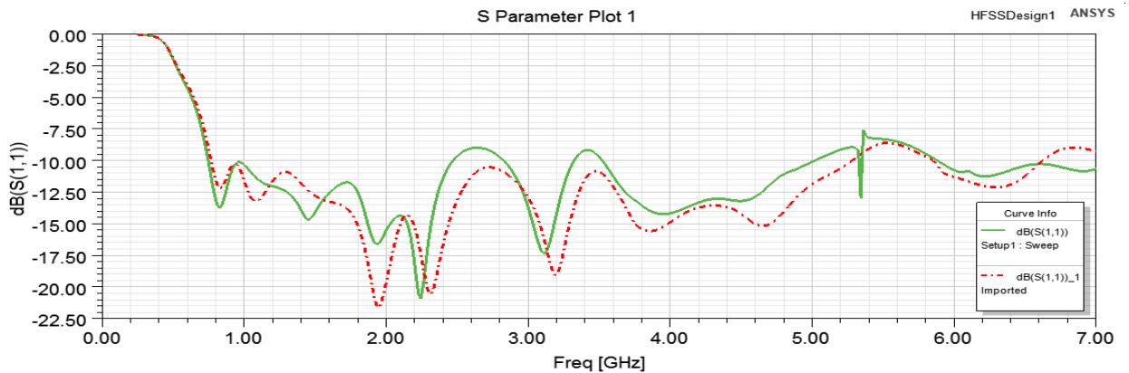
Рисунок 3.14. Частотные зависимости обратных потерь S_{11} при \varepsilon = 2
