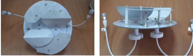
Рисунок 9. Прототип антенны MIMO 2×2 (антенна компании TONGYU)
