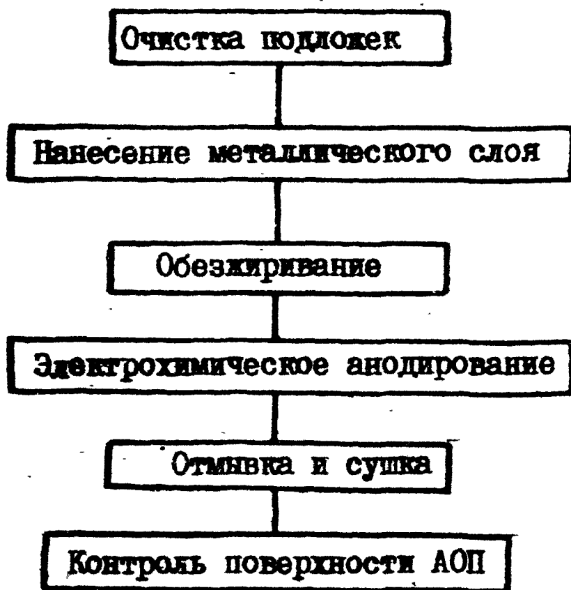
Рис.15. Схема технологического процесса получения тонких АОП для конденсаторов тонкопленочных микросборок
