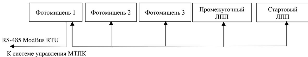
Рис. 11. Расположение модулей устройства позиционирования
