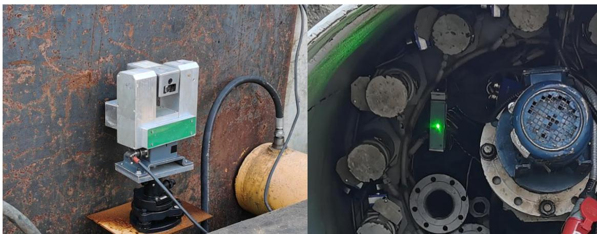
Рис.13. Экспериментальный образец лазерного приемо-передатчика и приемной фотомишени в процессе полевых испытаний
