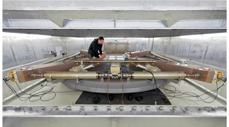
б) модульный КЛГ G с точностью  $10^{-14}$  рад/с, позволившей наблюдать эффект Чандлера (колебаниях земной оси длительностью более года) [281]
