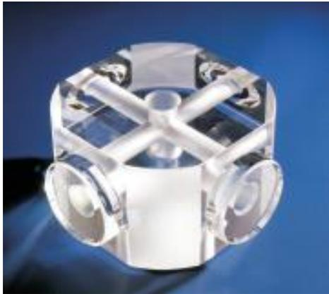
а) лабораторная установка к эксперименту [96]; Размеры: 55×55×35 мм; Добротность: 380000
