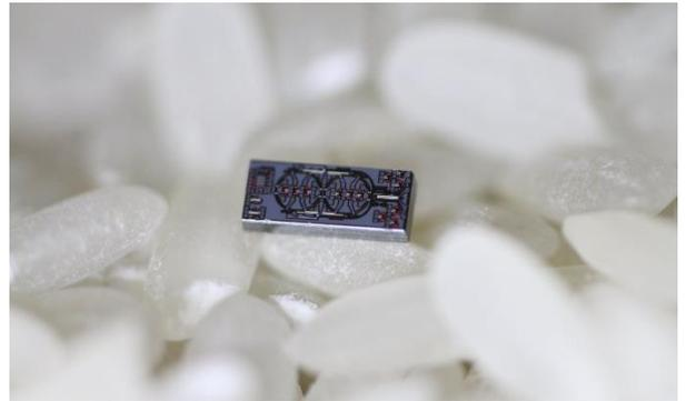
а) Действующий макет лазерного гироскопа В. Мацека и Д. Девиса [236]      б) Прототип самого маленького оптического гироскопа площадью  $2 \text{ мм}^2$  [237]
