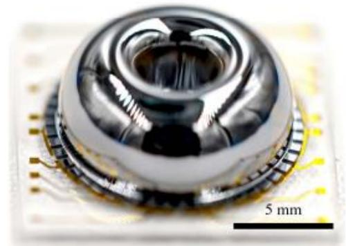
б) прототип высокоточного МЭМС гироскопа с зубчатой структурой [262]
