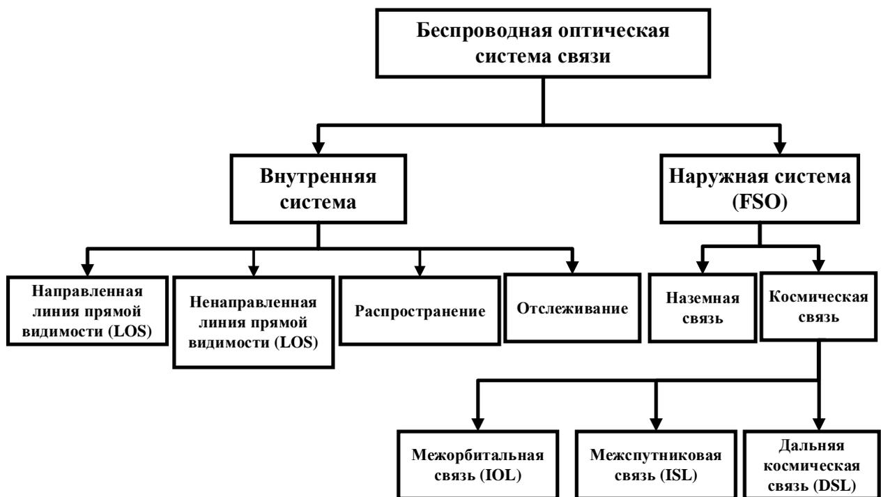
Рисунок 1.1– Классификация оптических систем беспроводной связи
