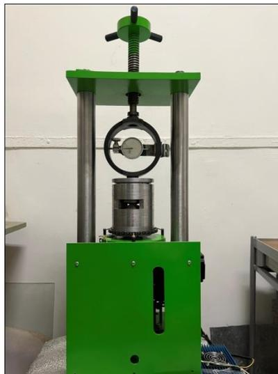
Рисунок 3 - Лабораторная установка для механоактивации порошков
