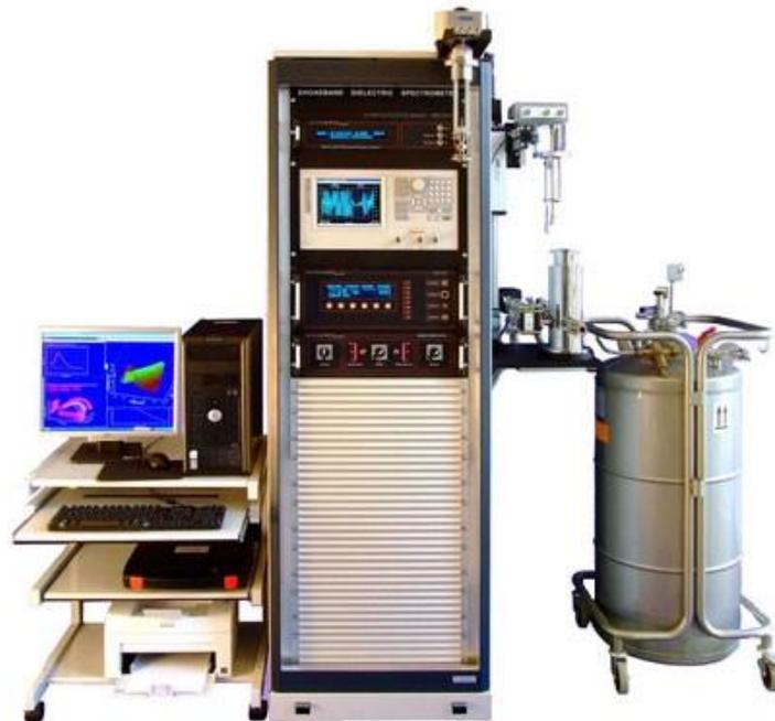
Рисунок 2.3 – Установка для комплексного измерения диэлектрических свойств материалов Novocontrol Alpha-A
