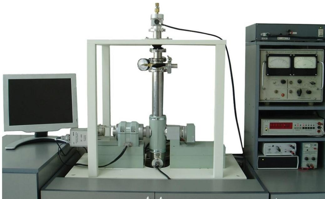
Рисунок 2.5 – Мессбауэровский спектрометр MS1104Em.
