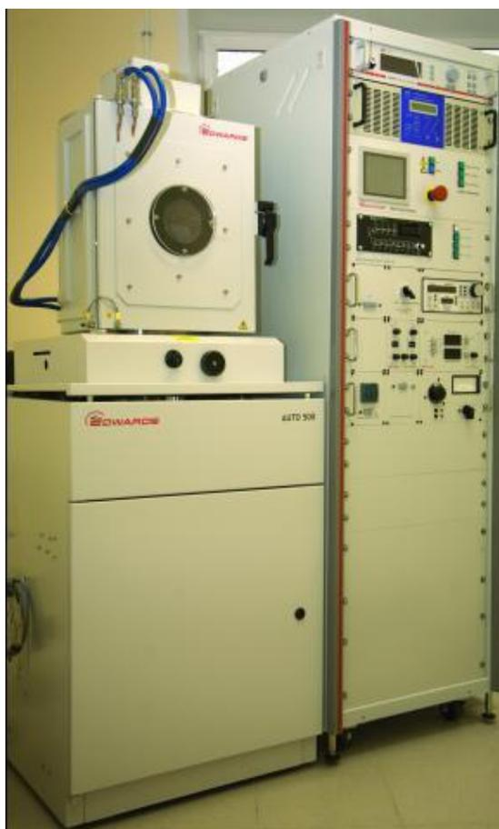
Рисунок 3.2 – Установка электронно-лучевого и магнетронного напыления AUTO 500
