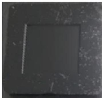
Рисунок 4.4 – МЭМС-сенсор на основе жёсткозакреплённой кремниевой мембраны
