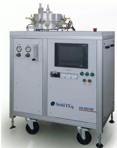
Рисунок 3.3 – Установка быстрой термической обработки STE RTA70H
