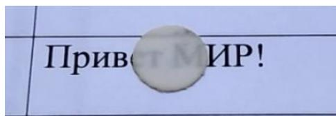
Рисунок 9 - Образцы прозрачной керамики состава  $[(\text{Na}_{0.90}\text{K}_{0.05}\text{Cd}_{0.05})_{0.95}\text{PZ}_{0.05}]\text{NbO}_3$ , полученной методом горячего прессования.
