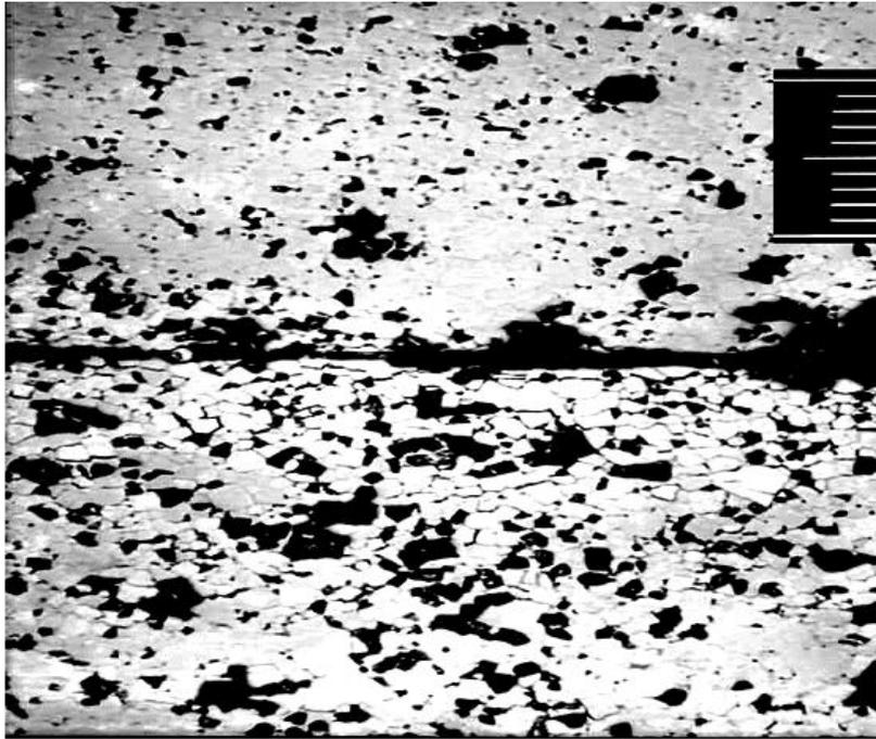
Рисунок 3.5 - Микрофотография Z-срезов образцов сегнетопьезоматериала на основе титаната свинца вблизи поверхностей. 1 деление = 10 мкм
