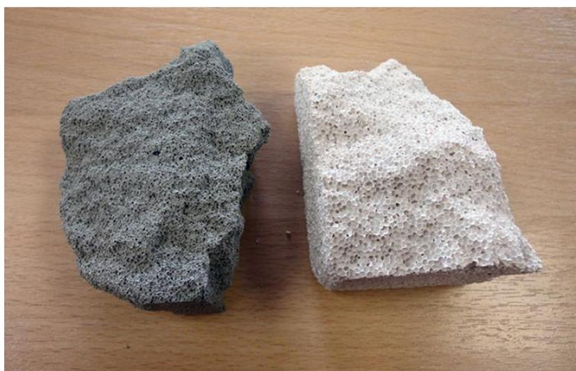
Рисунок 1.3 - Сколы пенобетонного (слева) и газобетонного блоков
