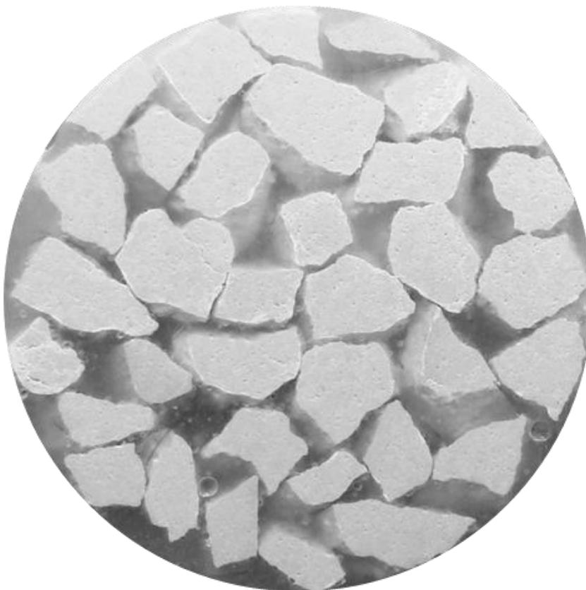
Рисунок 4.13 - Фотография образца однослойного композита «пьезокерамика - полимер», диаметр диска 20 мм
