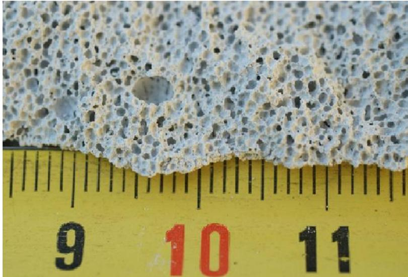
Рисунок 1.4 - Структура ячеистого бетона
