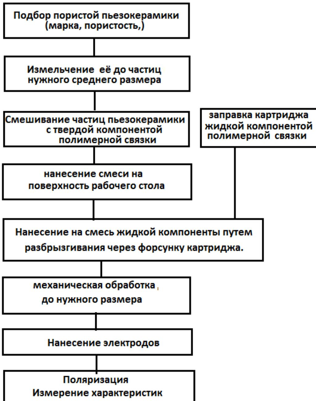
Рисунок 4.9 - Схема технологического процесса изготовления однослойного композита системы «пористая сегнетопьезокерамика-полимер»
