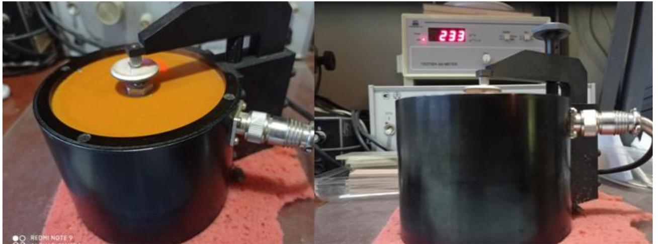
Рисунок 2.7 - Установка YE2730A  $d_{33}$  METER, предназначенная для измерения пьезомодуля квазистатическим способом
