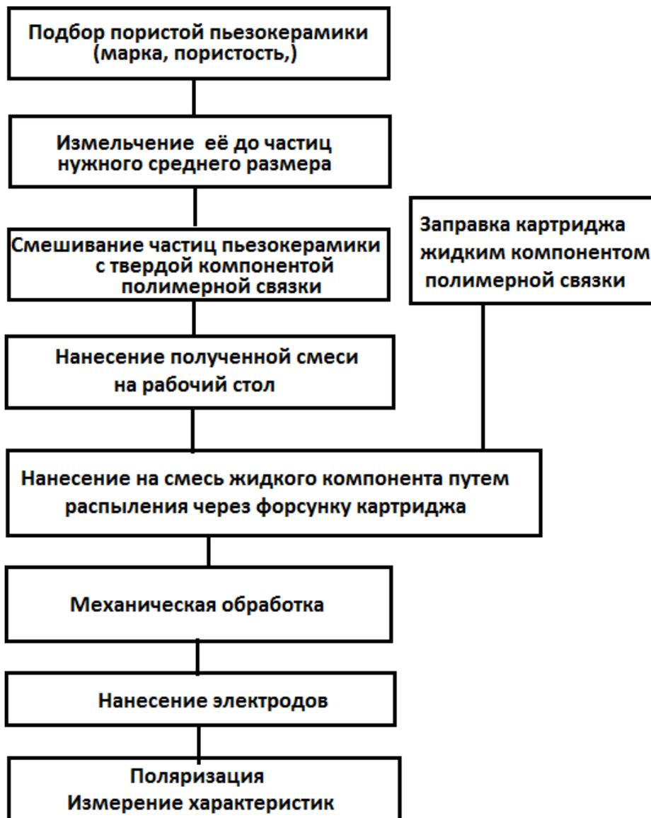
Рисунок 7 - Схема технологического процесса изготовления однослойного композита системы «пористая пьезокерамика-полимер»
