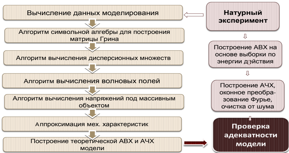
Рисунок 6 – Схема комплекса программ вычислительного и натурального эксперимента по проверке адекватности модели
