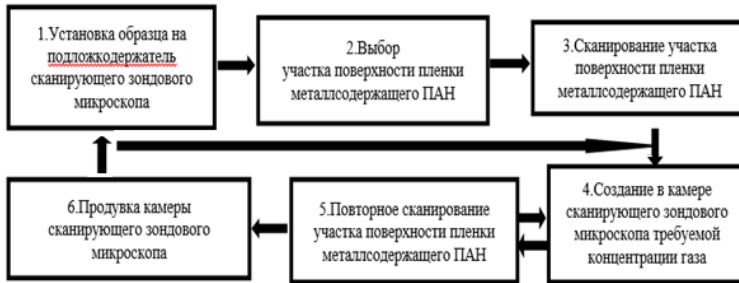
Рис. 12 Схема технологического маршрута экспресс-оценки изменения величины СВИ поверхности пленок кобальтсодержащего ПАН в зависимости от величины концентрации газов
