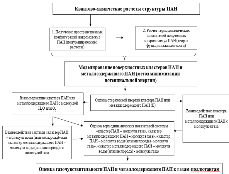
Рис.1 Алгоритм моделирования кластеров ПАН и металлсодержащего ПАН и анализа их газочувствительности
