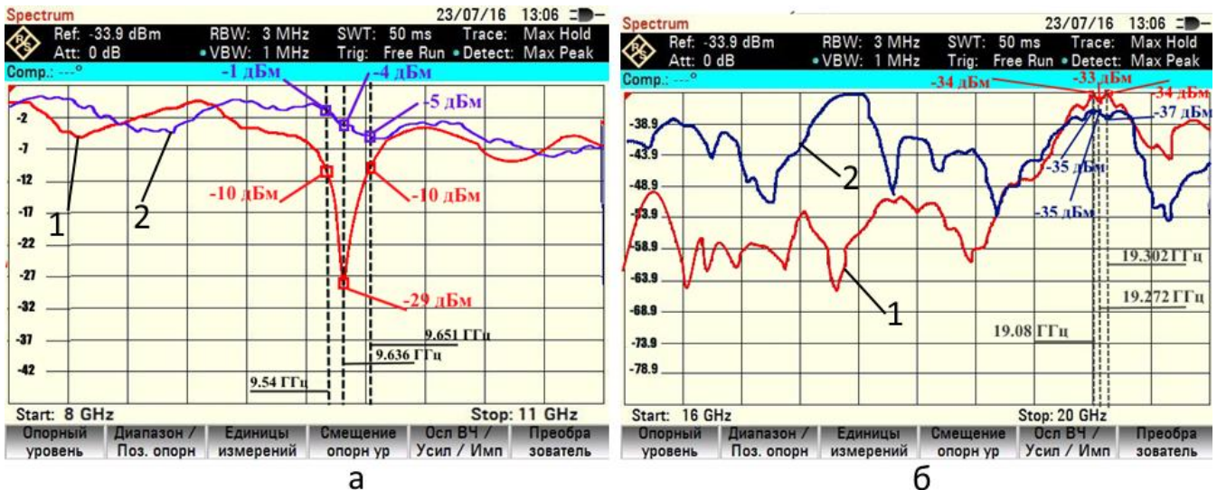
Рисунок 9 – ЧХ первой (а) и второй (б) гармоники поля, рассеянного макетом с подложкой из ММ (кривая 1) и воздуха (кривая 2) в «обратном» направлении
